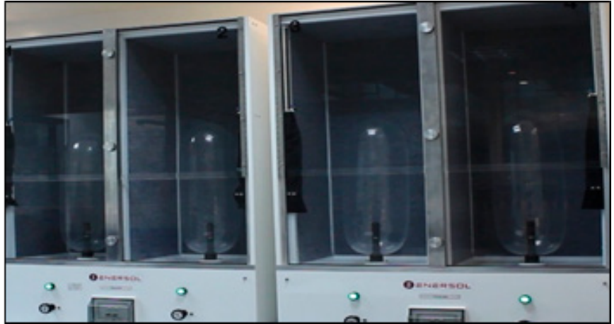
Ilustración 4. Ensayo de volumen y presión de estallido en preservativos
