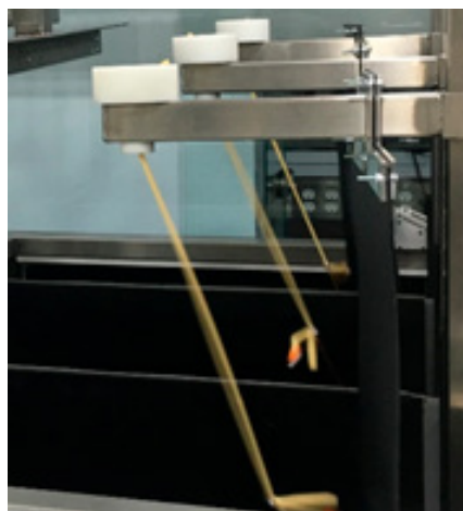
Ilustración 10. Ensayo Tracción del Balón Inflado
