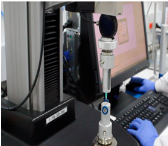
Ilustración 9. Ensayo unión entre el cono y la aguja en jeringas
