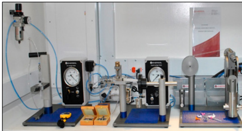
Ilustración 8. Ensayo de fugas de líquido y aire en jeringas
